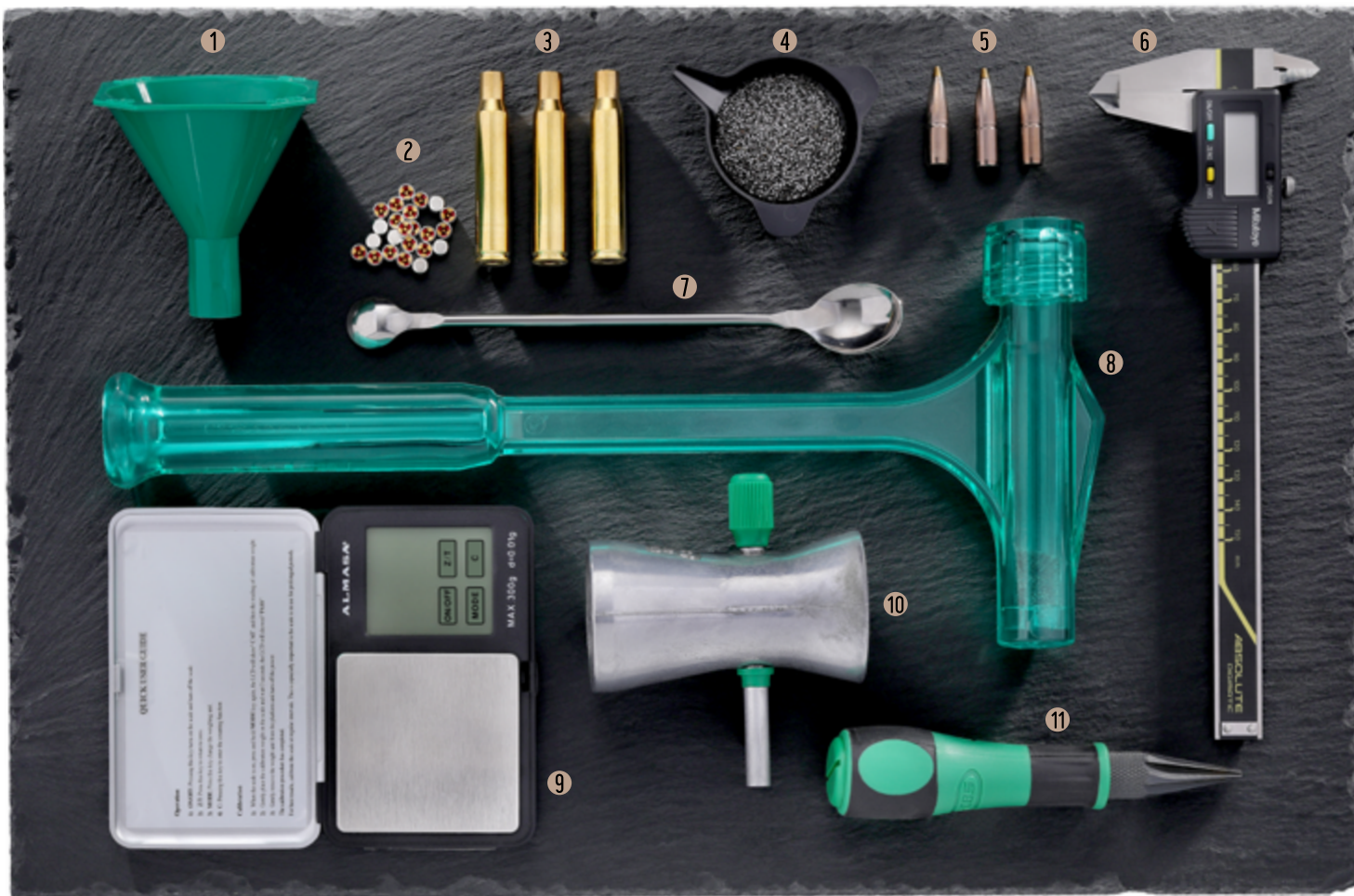
1 - Pulvertrichter, 2 - Anzündhütchen, 3 - Treibladungshülse, 4 - (Pulver) Waagschale, 5 - Geschoss, 6 - Digital Messschieber, 7 - Einwiegelöffel (Laborlöffel), 8 - Entladehammer (Delaborierhammer), 9 - Digitale Pulverwaage, 10 - Pulver Trickler (Pulver Feindsierer), 11 - Hülsenmundentgrater
