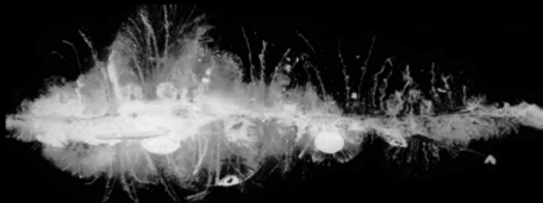
Simulierte Wundhöhle in Gelatineblock / Geschosswirkung in Gelatine
